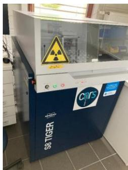
Spectromètre XRF dispersif en longueur d'onde (WDS)
